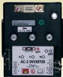
El control de la bomba hidráulica alimenta al motor de la bomba hidráulica únicamente a la velocidad requerida. La velocidad de elevación es proporcional a la palanca hidráulica de elevación maniobrada por el conductor. La función de inclinación y las funciones auxiliares trabajan a velocidades fijas; esto permite al sistema conservar energía por la entrega solamente del caudal hidráulico necesario.
