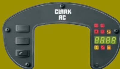
En el panel de control podemos encontrar toda la información necesaria como el contador horario, las luces de recordatorio del cinturón de seguridad y del freno de estacionamiento, además del indicador de batería descargada y los códigos de estado de la carretilla. Asimismo hay diversos indicadores adicionales que mantienen al conductor informado de la situación general de la carretilla en todo momento.
