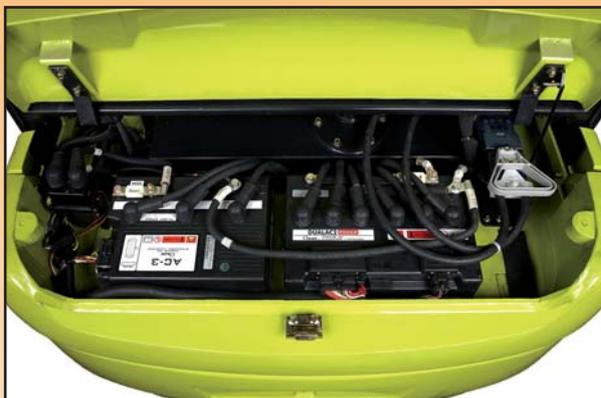
El control monitoriza constantemente la temperatura propia y la de los motores. Si la temperatura de cualquiera de ellos alcanzase su límite térmico establecido, el control reduciría gradualmente la alimentación de corriente al sistema para facilitar, de este modo, la reducción de temperatura. Cuando la temperatura vuelve a su estado normal, se reestablece totalmente la
