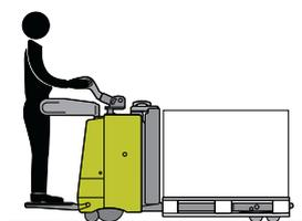
CPTP20ac con protecciones laterales fijas. Esta variante ofrece un soporte óptimo en las curvas y por lo tanto ayuda al conductor en todas las operaciones. Un sistema de amortiguación de la plataforma minimiza las vibraciones durante la conducción en pendientes.
