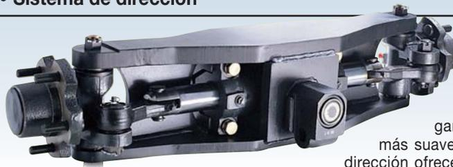
El resistente y perdurable eje de dirección ha sido diseñado con cojinetes de rodillos cónicos que garantizan una conducción más suave y precisa. El volante de dirección ofrece, además, una más fácil manipulación de la dirección y, lo que es más importante, el cilindro de dirección está totalmente protegido.
