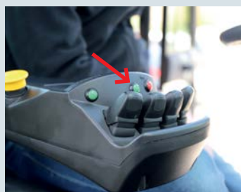
Interruptor de activación del VMS en la minipalanca
